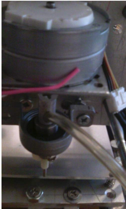
Рис. 2.4 – Біполярний кроковий двигун для позиціонування деталі
