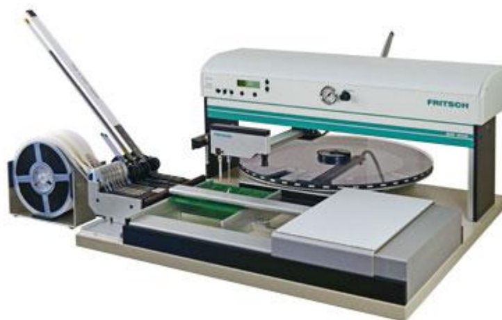
Рис. 1.4 – Напівавтоматичний маніпулятор Fritsch SM902
